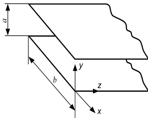
Рис. 4 Двухпроводная линия, состоящая из двух сверхпроводящих плоскостей.
