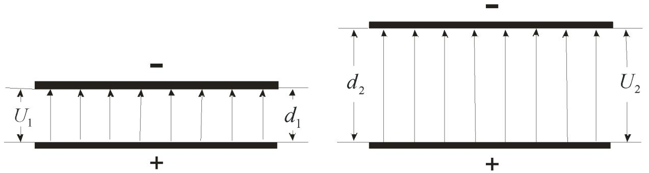
Рис. 1. Электрические поля плоского конденсатора при разном расстоянии между его пластинами.
