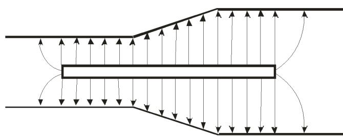
Рис. 2. Коаксиальный конденсатор с переменным сечением.
