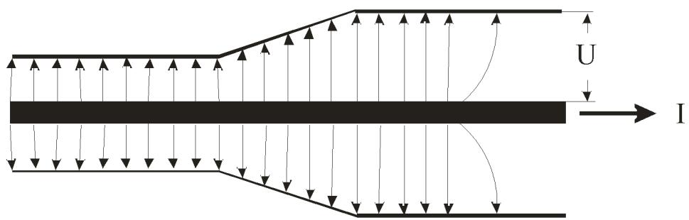
Рис. 3. Распространение сигнала по коаксиалу с переменным сечением.
