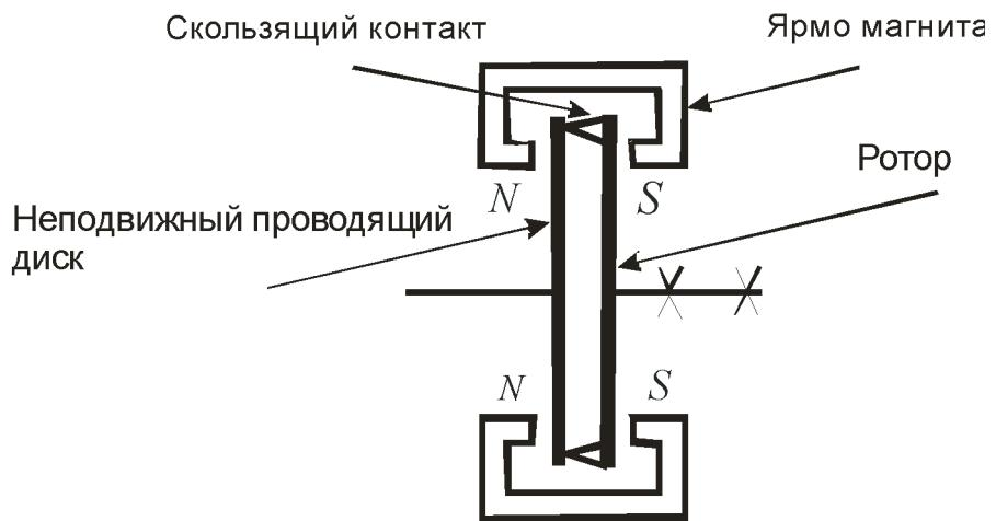
Рис. 1. Осевое сечение многополюсного унипольного генератора.
