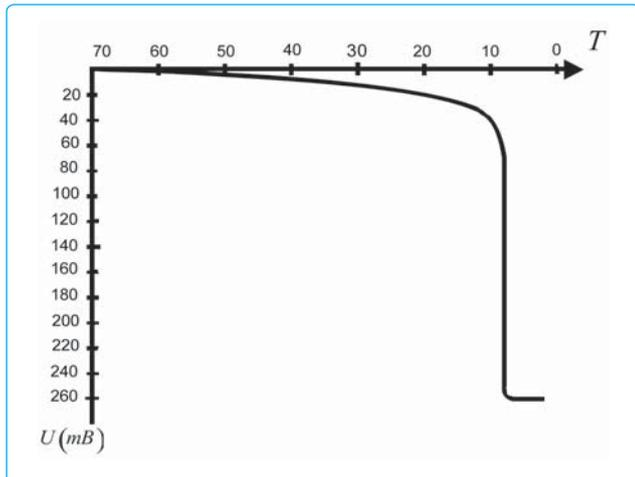
Рис. 1. • Зависимость потенциала ниобий-титанового образца от температуры
