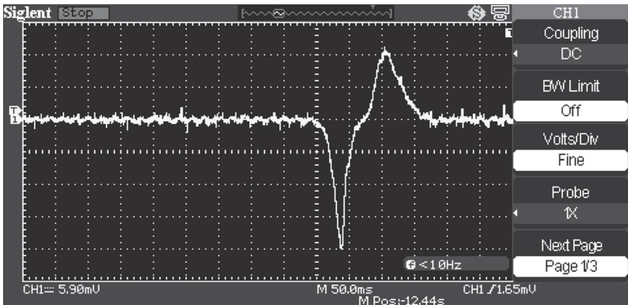
**Рис. 20.** • Форма импульса, полученная при быстром введении и последующем быстром изъятии из клетки Фарадея заряженного образца янтра
