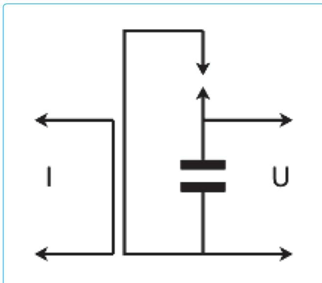
Рис. 23. • Схема измерения падения напряжения на конденсаторах во время их разряда через разрядник, а также сигнала, пропорционального току разряда
