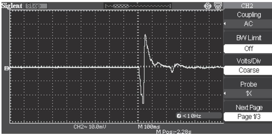
Рис. 11. • Импульс, полученный при разрыве проволоки
