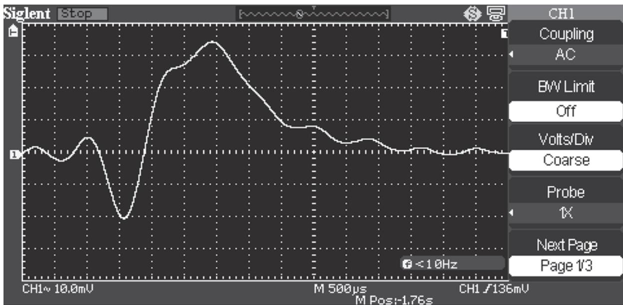
**Рис. 25.** • Форма импульса напряжения между внешним экраном и экраном клетки Фарадея, полученная при разряде конденсаторов емкостью 6000 мкФ, заряженных до напряжения 300 В. Цена деления по оси X составляет 500 мкс.
