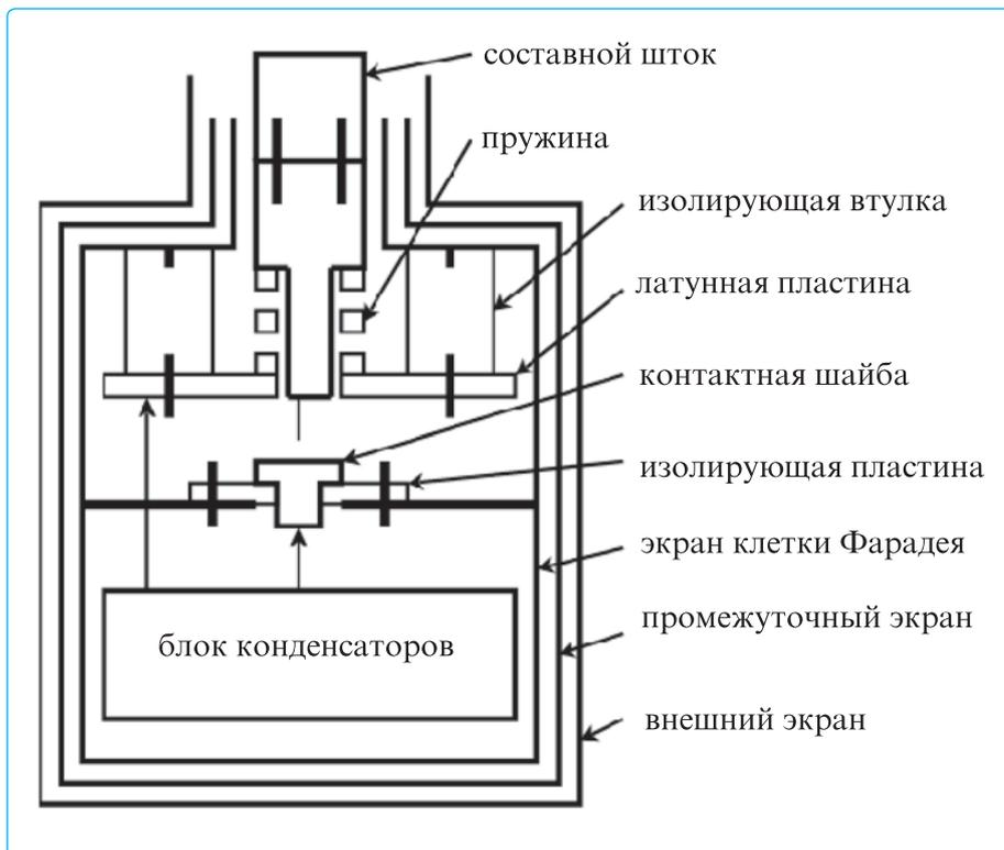
Крепежные болты и шпильки на рисунке показаны жирными отрезками линий. Разъемы, позволяющие подключать осциллограф между экраном клетки Фарадея и внешним экраном, а также между внешним и промежуточным экраном на схеме не показаны. Не показаны также разъемы, через которые осуществляется заряд конденсаторов. При измерениях кабель, через который осуществляется заряд конденсаторов, от клетки Фарадея отключался.
