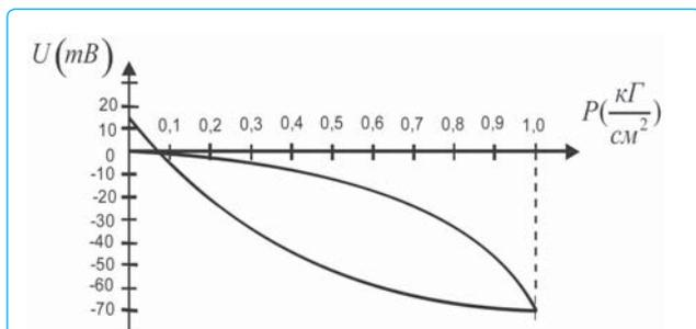
Рис. 2. • Зависимость потенциала медной колбы от наружного давления
