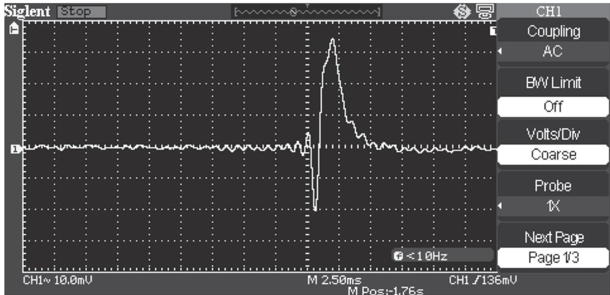
**Рис. 24.** • Форма импульса напряжения между внешним экраном и экраном клетки Фарадея, полученная при разряде конденсаторов емкостью 6,000 мкФ, заряженных до напряжения 300 В. Цена деления по оси X составляет 2,5 мс.
