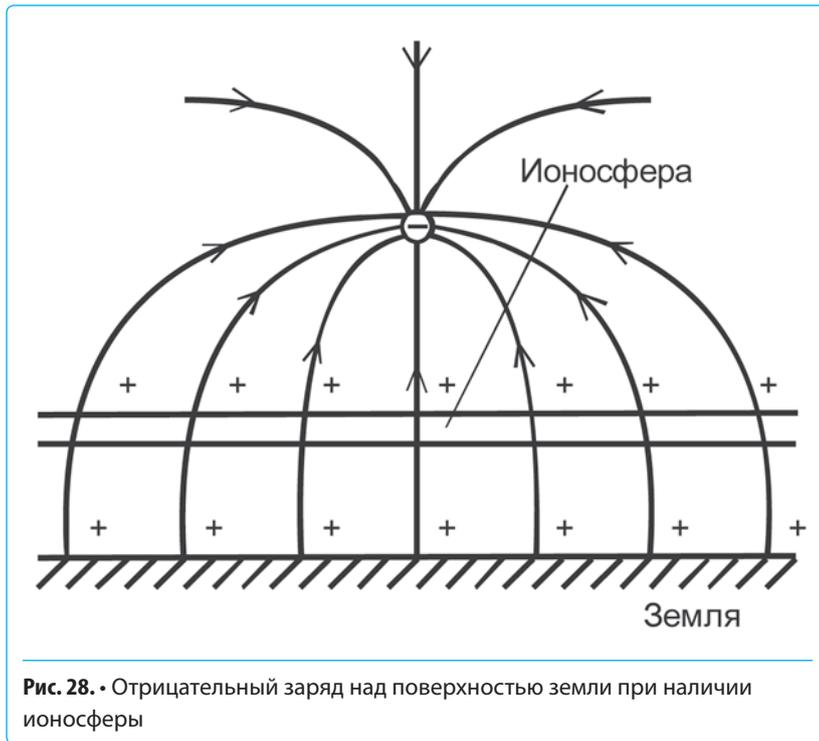
Рис. 28. • Отрицательный заряд над поверхностью земли при наличии ионосферы
