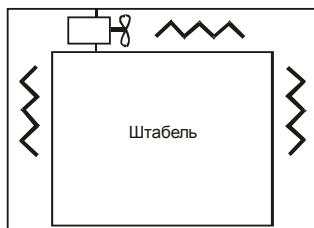
Рис. 5. Схема камеры с верхним расположением вентилятора.
