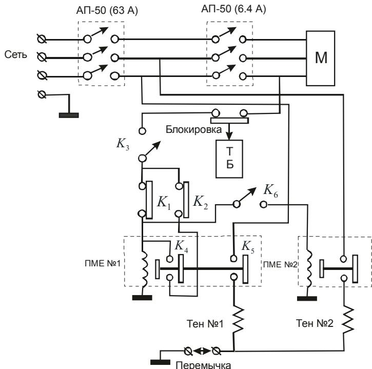
Рис. 28. Электрическая схема универсальной камеры.
