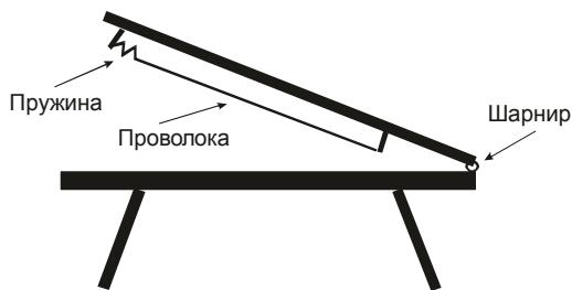
К рабочему столу на шарнире крепится доска, на которой расположены два металлических штыря. Между концами этих штырей растянута никромовая проволока толщиной 0.5 мм. Для того чтобы при нагревании проволока не провисала, используется пружина. К проволоке через понижающий трансформатор подводится напряжение, которое подбирается таким образом, чтобы нагретая проволока быстро плавила пенопласт.
