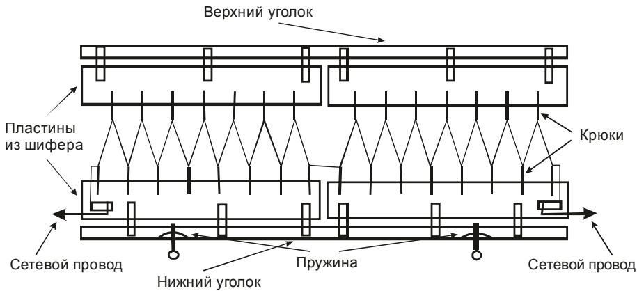
Рис.21. Конструкция тэна.
