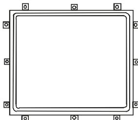
Рис. 15. Схема крепления уплотняющего шланга и уголков затяжки двери.
