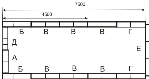
Рис. 14. Последовательность установки блоков камеры.
