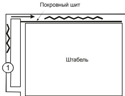
Рис. 7. Камера с внешним расположением вентилятора.
