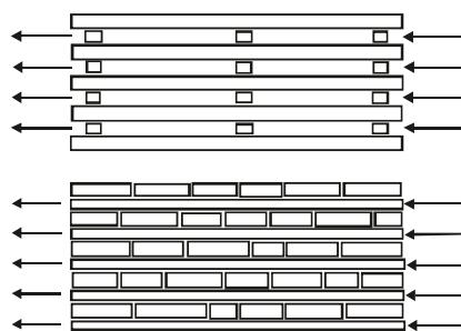
Рис. 4. Схемы продувки штабеля.
