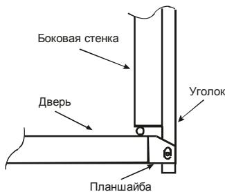
Рис. 16. Узел подвески двери к стенке камеры.
