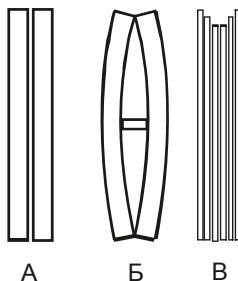
Рис. 1. Схемы упруго-вязких деформаций древесины во время сушки.
