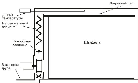
Рис. 29. Схема конденсационной камеры.
