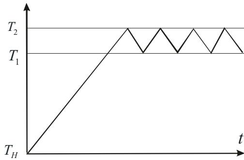
Рис. 24. Температурный график циклического режима сушки.
