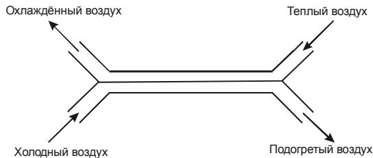
Рис. 10. Схема действия рекуператора.
