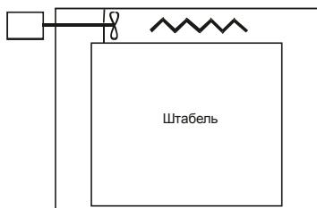
Рис. 6. Схема камеры с внешним расположением двигателя.
