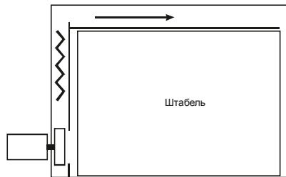
Рис. 8. Схема камеры с внешним расположением двигателя и внутренним расположением центробежного вентилятора.
