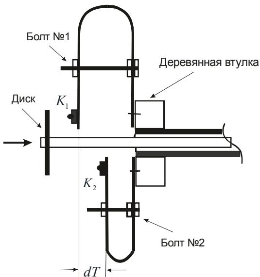
Рис. 26. Исполнительный механизм датчика температуры.
