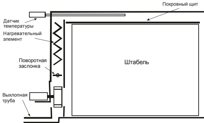
Рис. 11. Схема универсальной сушильной камеры.
