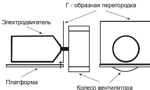
Рис.19. Компоновка вентилятора на платформе.
