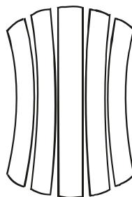
Рис. 2. Торцевой вид досок после их сушки.
