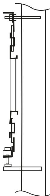
Рис. 23. Крепление крюков на шиферных пластинах и тэнов в камере.
