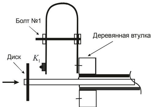
Рис. 28. Схема блокировочного датчика.
