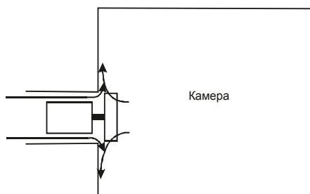
Рис. 9. Использование эффекта Бернули для подсоса воздуха в камеру.
