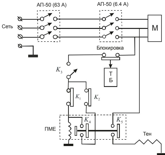
Рис. 27. Электрическая схема камеры для сушки одного штабеля
