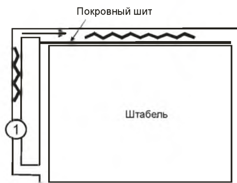
Рис. 7. Камера с внешним расположением вентилятора.
