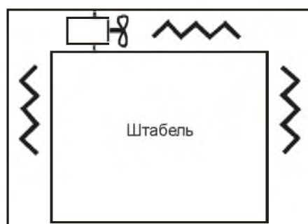
Рис. 5. Схема с верхним расположением вентилятора.
